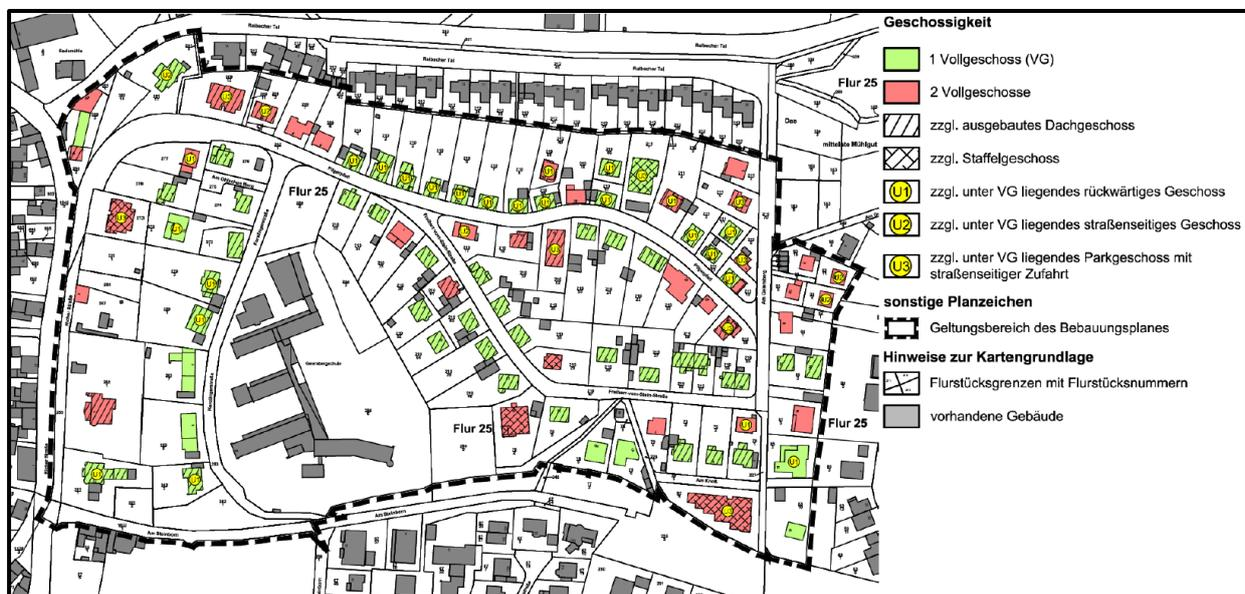
**Abbildung 10 Bestandserhebung zur Geschossigkeit**
