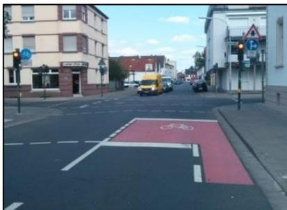
Abbildung 22: Beispielhafte Aufstellfläche für den Radverkehr am Knotenpunkt [8]
