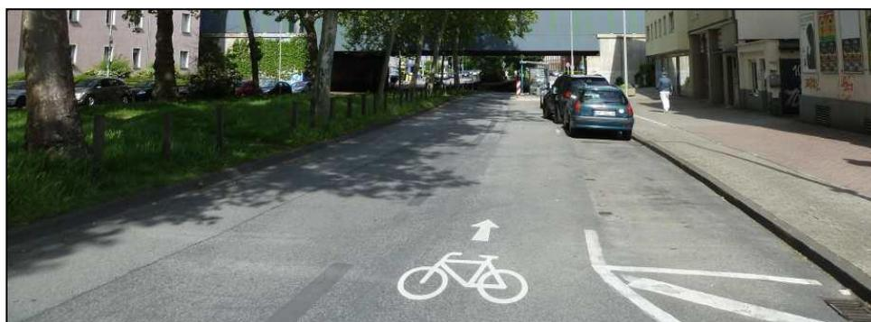
Abbildung 7: Markierung von Fahrrad-Piktogrammen zur Verdeutlichung der Aufhebung der Radwegebenutzungspflicht [15]
