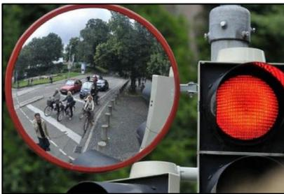
Abbildung 20: Trixi-Spiegel zur Sichtfeldverbesserung im „Toten Winkel“ [9]
